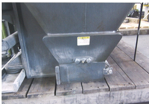
ホッパー底部には作業終了後の洗浄水の排出口を設けています
