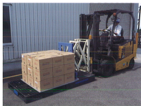
シートパレットを手前のパレットに引き込みます
